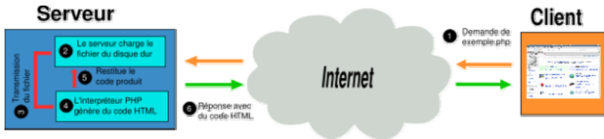
Figure2.5. Principe de fonctionnement de PHP.
