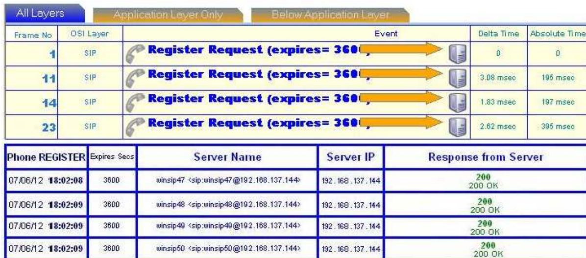
Figure 4. 8: Déroulement de l'enregistrement des utilisateurs auprès d'asterisk
